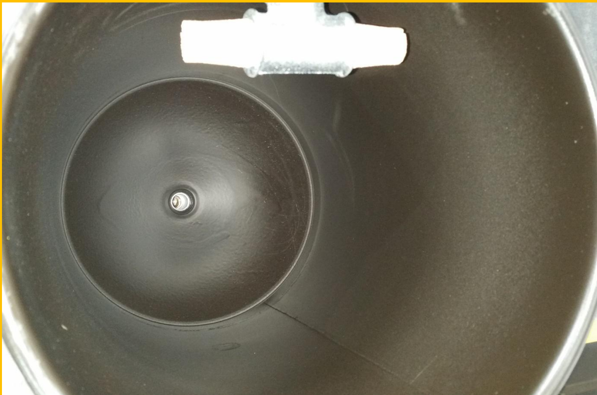
Direkter Zugang in den Strahlkessel (blitzschneller Strahlgutwechsel)
